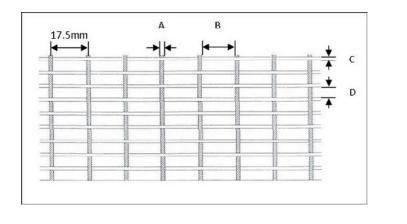
A – Warp Cable B – Warp Gap C – Weft Wire D – Weft Gap
