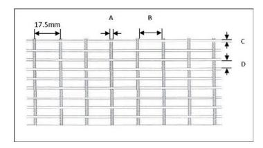
A - Warp Cable B - Warp Gap C - Weft Wire D - Weft Gap
